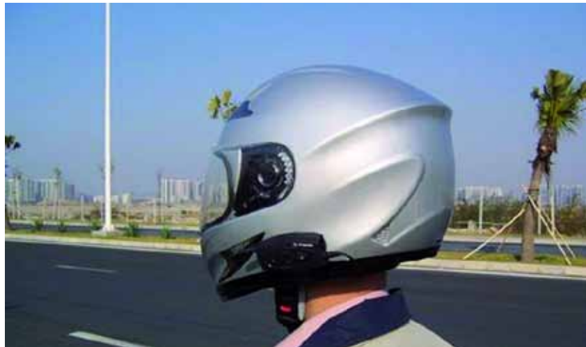
(Unidad BIM instalada en el casco)
